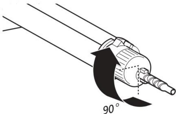
3. Зафиксируйте смесительный наконечник, повернув его по часовой стрелке на 90°.
