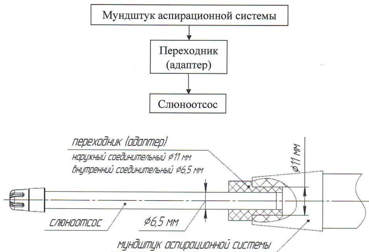
Рисунок 3 – схема подключения слюноотсоса к аспирационной системе с помощью переходника
