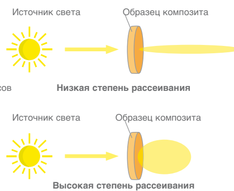
Рисунок 6: Рассеивание светового потока разными композитами
